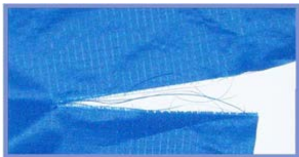
図K.1.1.1 織られたプライ、裂くことができバラバラになった繊維を見せる
