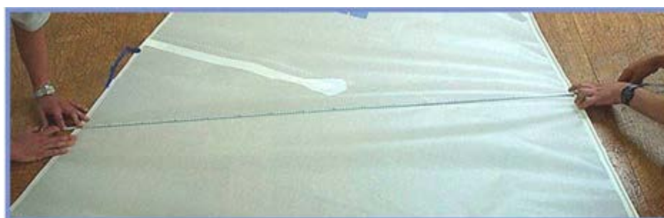
図K.2.3.4 しわを取り除くためのセールへの適切な張力
