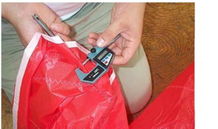
図 K.1.2.3 マイクロメーターとすきまゲージを用いてのプライ厚さ計測
