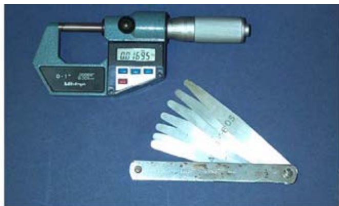
図K.1.2.3 セールクロス厚さ計測用分解能0.001 mmのデジタル・マイクロメーターとすきまゲージ
