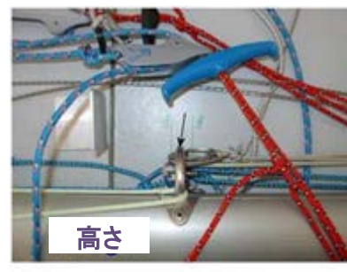
スパーに対し90°でハリヤードが付いてのスピネーカー・ホイスト高さ
