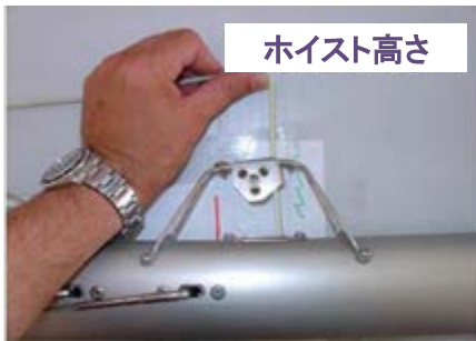
スパーに対し90°でハリヤードが付いてのスピネーカー・ホイスト高さ
