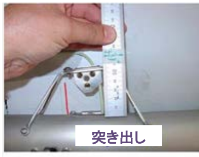
スパーに対し90°でハリヤードが付いてのスピネーカー・ホイスト高さ
