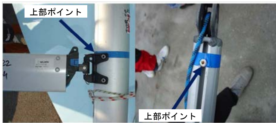
図J.2.1 マストの上部と下部のマークとポイント
