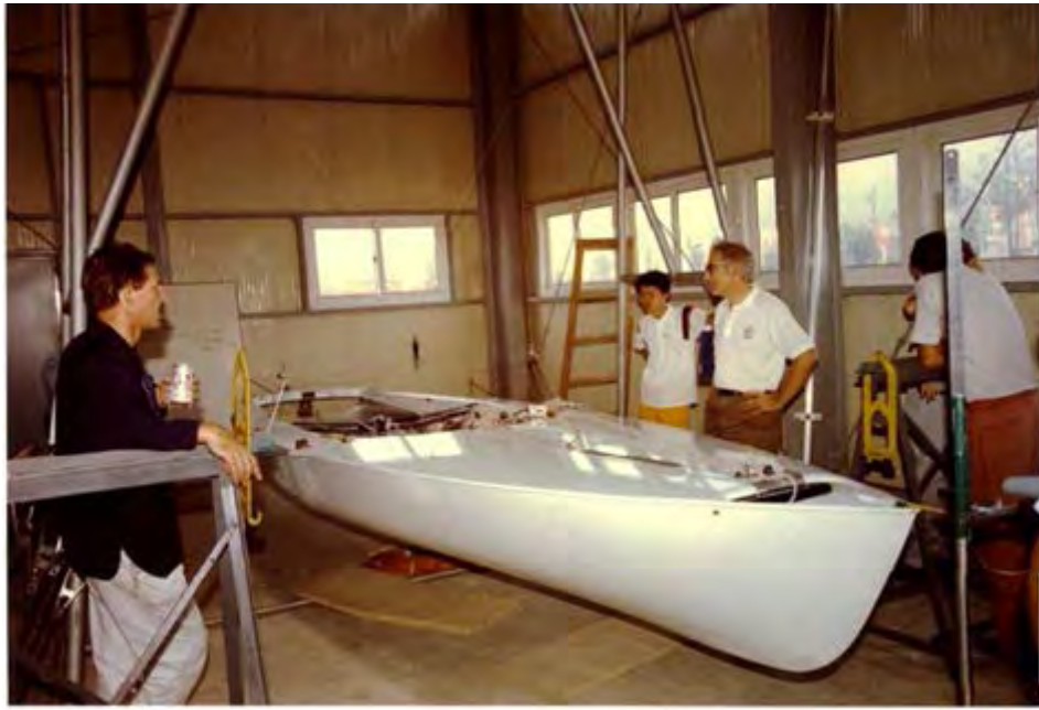
図H.4.8.2 1988年釜山オリンピックでの2本吊りのフライング・ダッチマン。計量フックとクロス・ワイヤーに注目せよ。ランボリー・フックは比較のためのこれに続くピッチ環動半径計測に用いられた。
