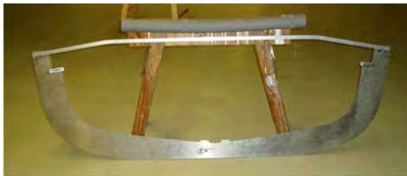
図H.1.5.1.2 整列用、ピンで留めた硬いクロスバーとシアーでの調整可能な突起のあるジュラルミンで作られた全断面 FD 級テンプレート。ただし、重ねて、テンプレート・エッジから 10 mm でのベースラインはない。署名は、このテンプレートが基準マイラー設計図に対してチェックされたことを示す。
