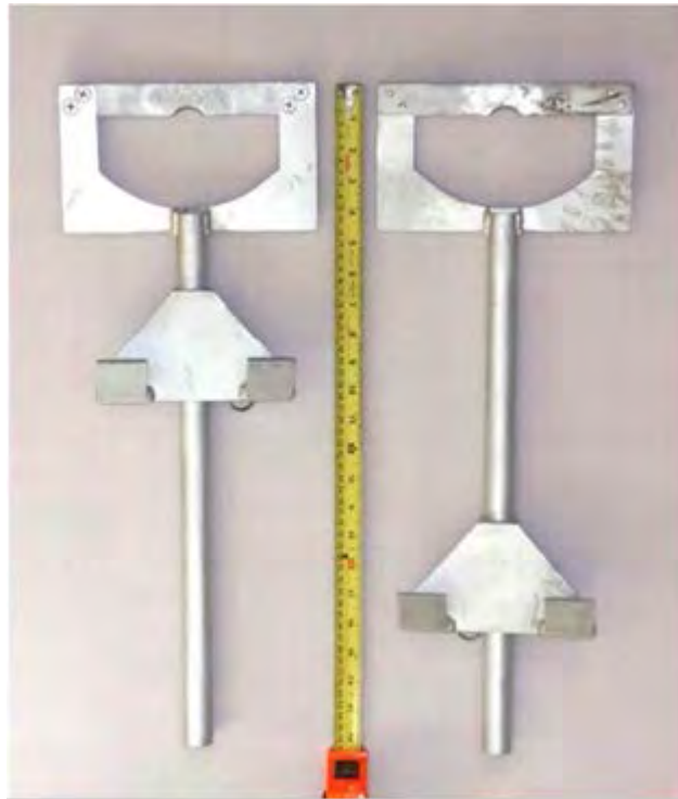
図H.4.2.5 ヨーロッパ級の軸01と軸02でのフックの形状
