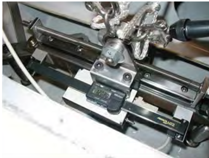
図H.4.7.2 2004年傾斜スイング・システムは、イングリングのキール・ボルトに設置された。スイング軸受けは、精密なレールに取り付けられ、位置は電子スケールで読む。「レール・スケール」の下箱は、傾斜計である。ローラ・ベアリングと支持のためのシャックルと吊り下げの固定ラインは、最上部に見られる。
