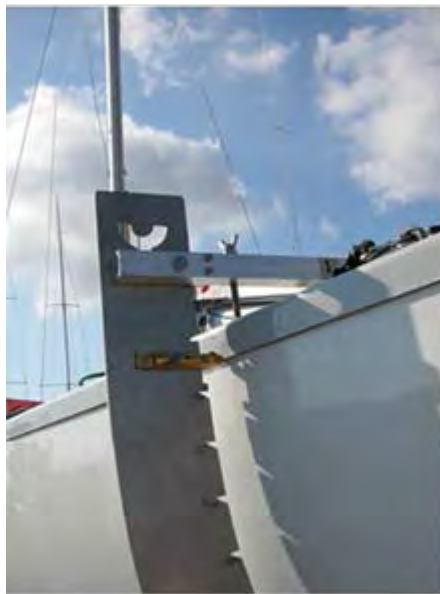
図H.1.5.1.1 計測点での三角の切欠きとテンプレート・エッジから 10 mm のベースラインがないことを示している ISAF が作ったイングリグ級テンプレート。クロスビームと真ちゅう製アジャスターは、必須の追加した細部である。テンプレートの幅を精密に維持する位置決めピンに注視すること。
