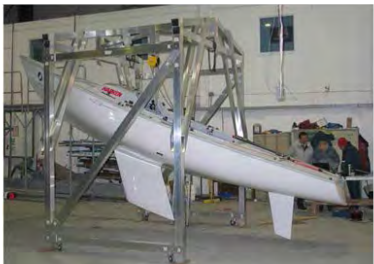
図H.4.7.2 2004年傾斜スイング・システムは、イングリングのキール・ボルトに設置された。スイング軸受けは、精密なレールに取り付けられ、位置は電子スケールで読む。「レール・スケール」の下箱は、傾斜計である。ローラ・ベアリングと支持のためのシャックルと吊り下げの固定ラインは、最上部に見られる。
