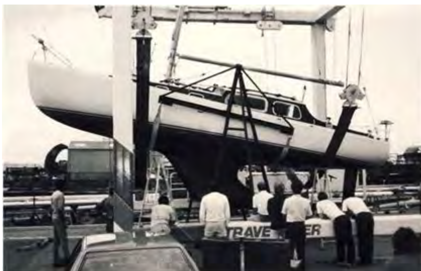
図H.4.6.1 1987年ニュー・ジーランドでスイング・テスト進行中のスチュアート34級
