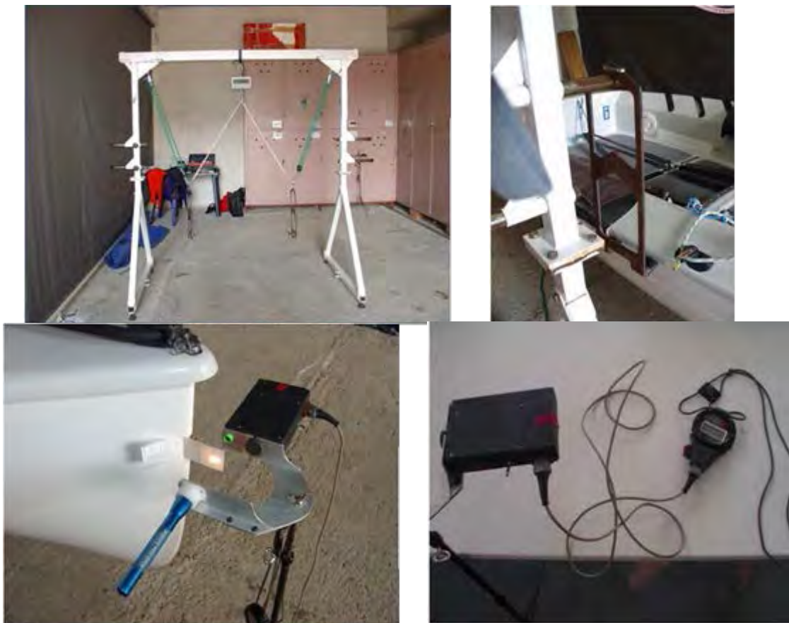
図H.4.2.1 対の格納できるナイフ・エッジ、200 mm 離れた軸受けのあるフィン級フック、計時のためのフォトセルを示す現代のフィン級ランボリー・システム
