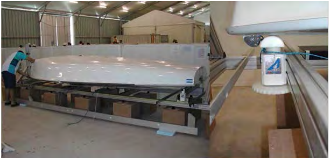
図H.1.48 上にハルをのせたスペインの470級ジグ（左）とモジュールの枠組みと水平調整ねじの詳細（右）
