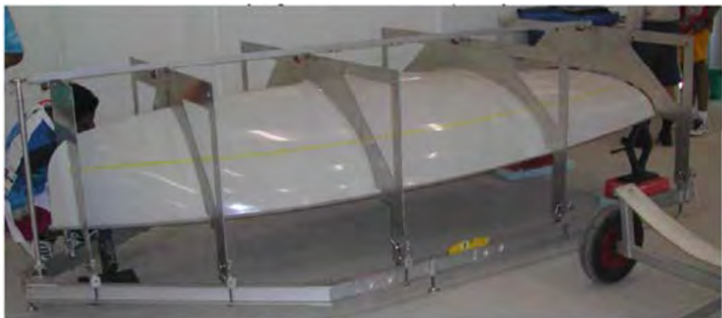
図H.1.4.10 自動車用ジャッキを用いて水平にし、並べたジグの内側のヨーロッパ級ハル
