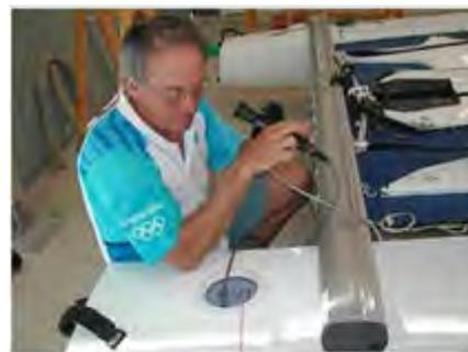
右に示す小型の検査カメラのように、より手ごろな価格の器具が、近頃は簡単に得られるようになってきている。このように LED ライトと外部モニターにイメージを送る機能を内蔵しているので、セーリング装備の検査と検査の目的に十分かなっている。
