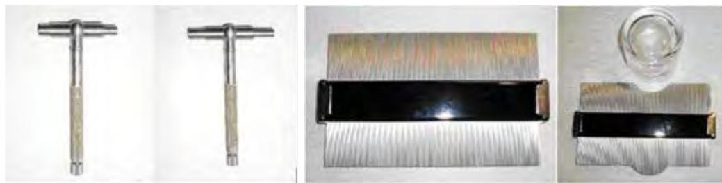
左の道具は、センターボード・ケースの内側の幅を計測するために用いることができる。2つの円筒は、バネで留められており、幅を調節して、その後底のつまみをしっかりと締め、定位置に置く。実際の寸法は、ノギスを用いて測る。
