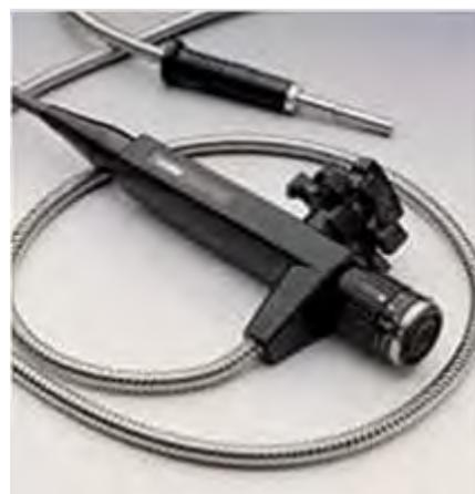
また、観察部内に組み込まれたのは、光ファイバー・ケーブルの検査端の操作ができる 4 方向角度測定調整。光ファイバー・ケーブルの端の 50 mm 長さは、半球弧の上を眺めることができるように操作でき、その上に、適切なカメラで、検査中の対象物の写真を撮ることができる。
