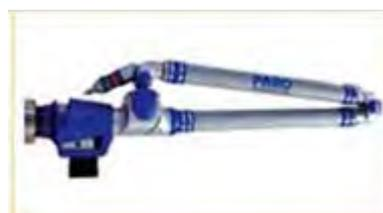
例えば、ラダーのようなより小さい部分については、デジタル・アーム（上の右）のような3D デジタイザー（3D スキャナ）が、設計形状との比較のために3D 形状データを作り出すために用いることができる。
