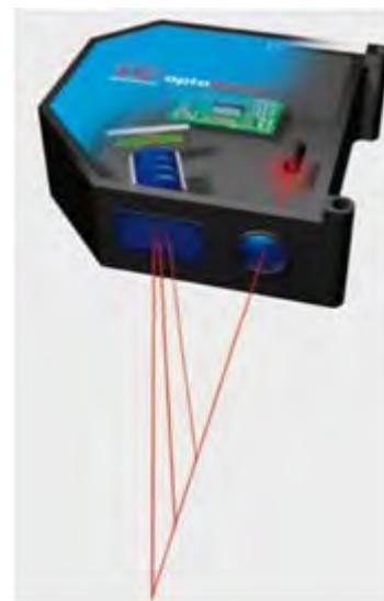
図 F.6.2.2 レーザー三角測量センサー
