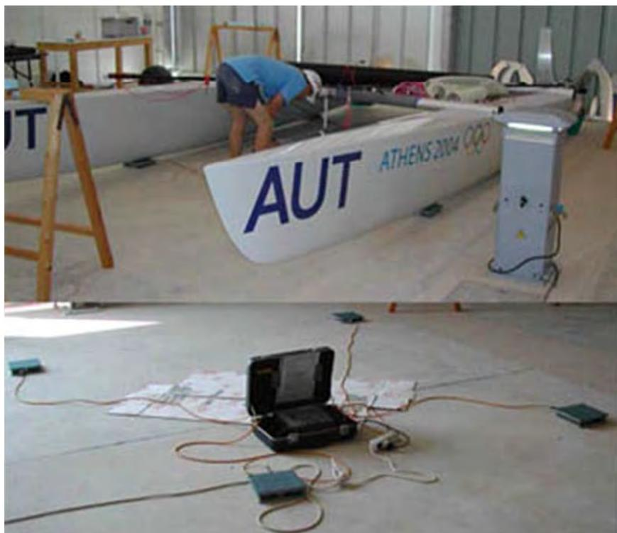
図 F.7.1.9 4パッドのはかりを用いるトーネード級の計量
