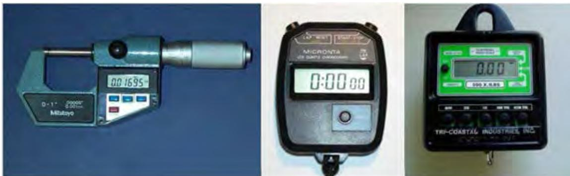
図 F.4.8 機器の分解能、マイクロメーターの分解能 0.001 mm、ストップ・ウォッチの分解能 0.01 s、秤の分解能 0.05 kg
