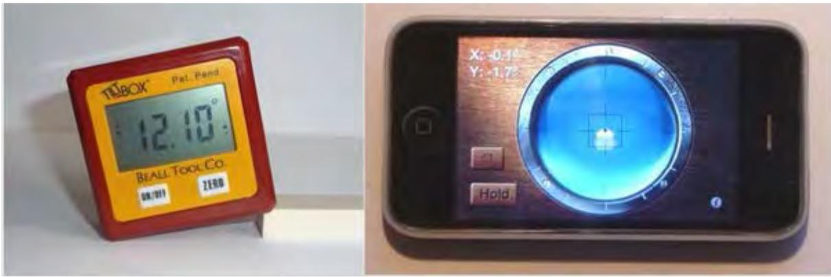
図 F.6.5.2 分解能 0.05 度の傾斜計と分解能 0.1 度の 아이폰水準器
