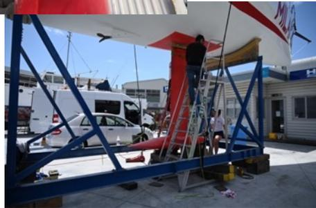
第2レグの途中でキールの異音により、ケープタウンに緊急入港し、応急処置を行い、その後、オークランドで大きな修繕を行った。
