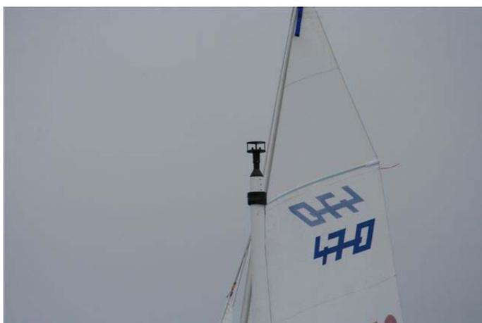
イギリスのコーチボートには特殊な風見がついて高さが高くなり、ピッチングでキャップが壊れないで測定できるように工夫してあります。
