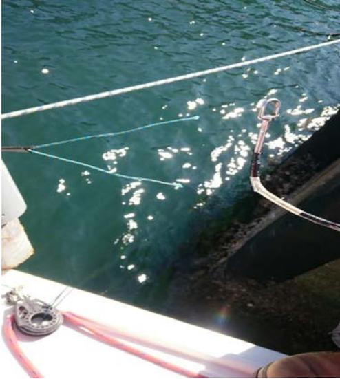
写真のラニヤードは去年の 8 月に行った船の整備の際に張り替えた。張替の際、ラニヤードの巻が足りなかったことが、切れた原因と思われる。また紫外線避け用のテープを巻いていたため、巻具合が直接見えない状態であった。
