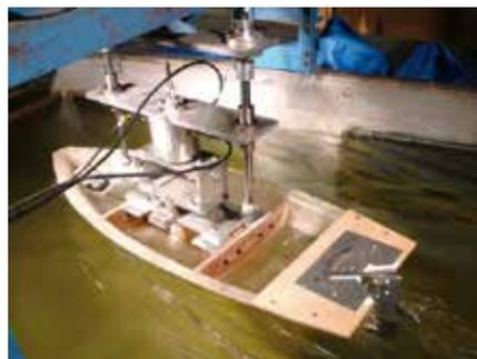
図4-1 1/5模型を用いた回流水槽試験の様子
