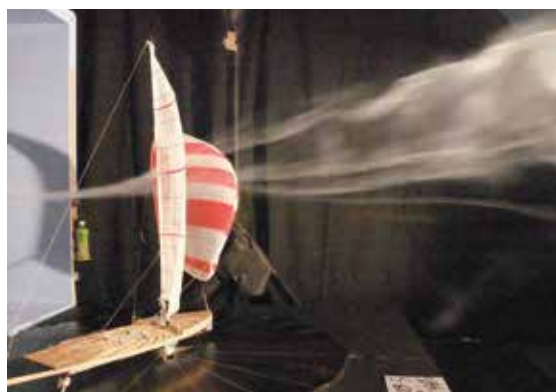
図8-2 煙による流れの可視化と計算による流線の比較（風向120°、上から）
